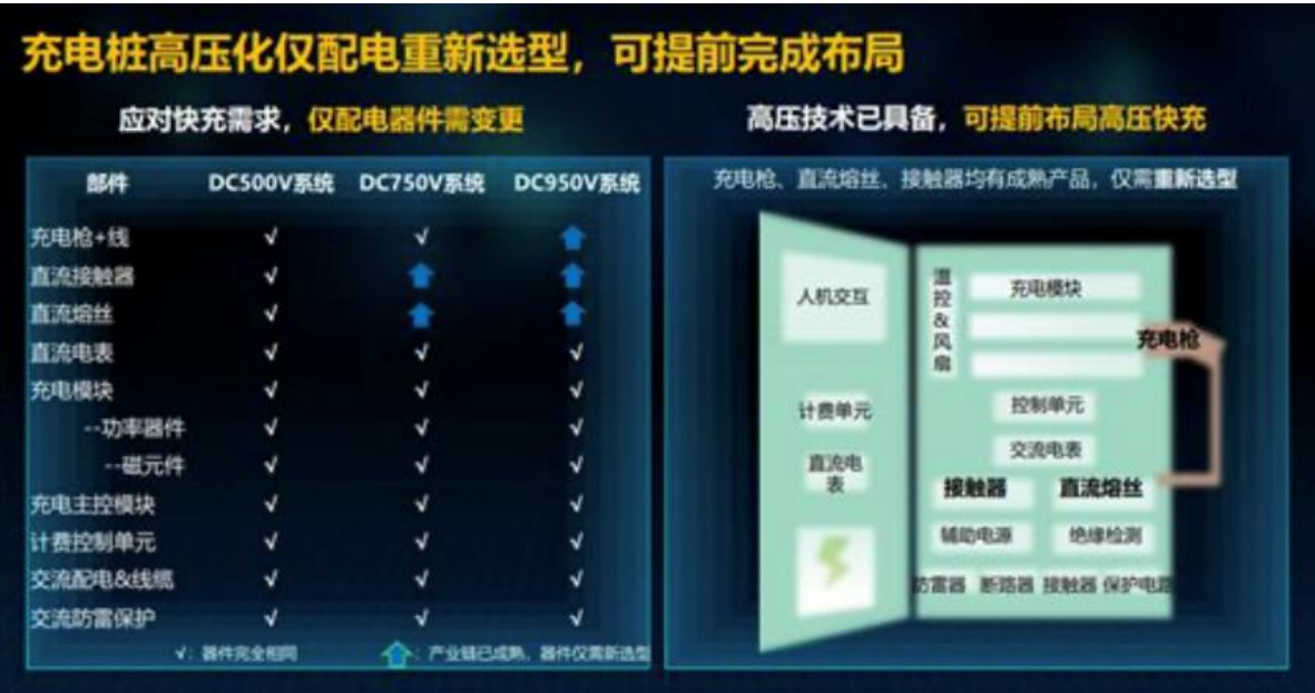
图：高压充电桩仅需变更配电器件
