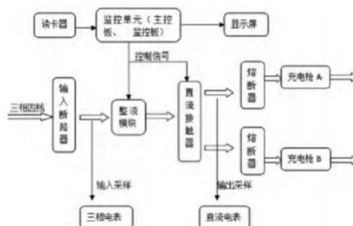
图7. 直流充电桩电气系统原理图
