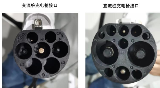
图23. 交流充电桩和直流充电桩充电枪接口对比
