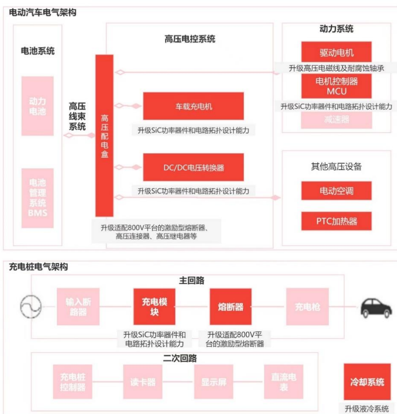
图 10：800V 电压平台带动车桩关键组件升级
