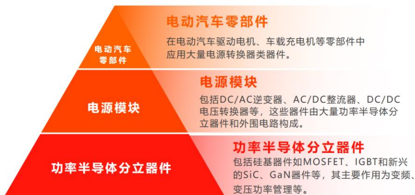
图 11：电动汽车车用零件层级示意图
