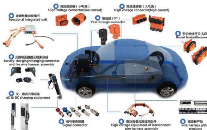
图 19：电动汽车高压连接器应用场景
