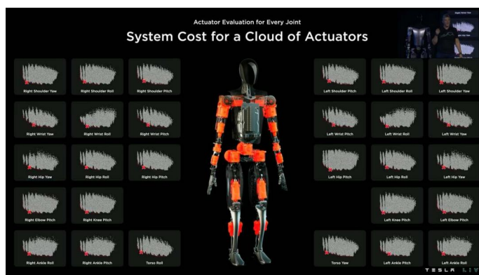
图 73：28 个关节选出各自最优执行器
