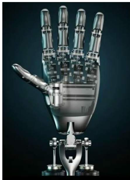
图：特斯拉Optimus双手共12个执行器
