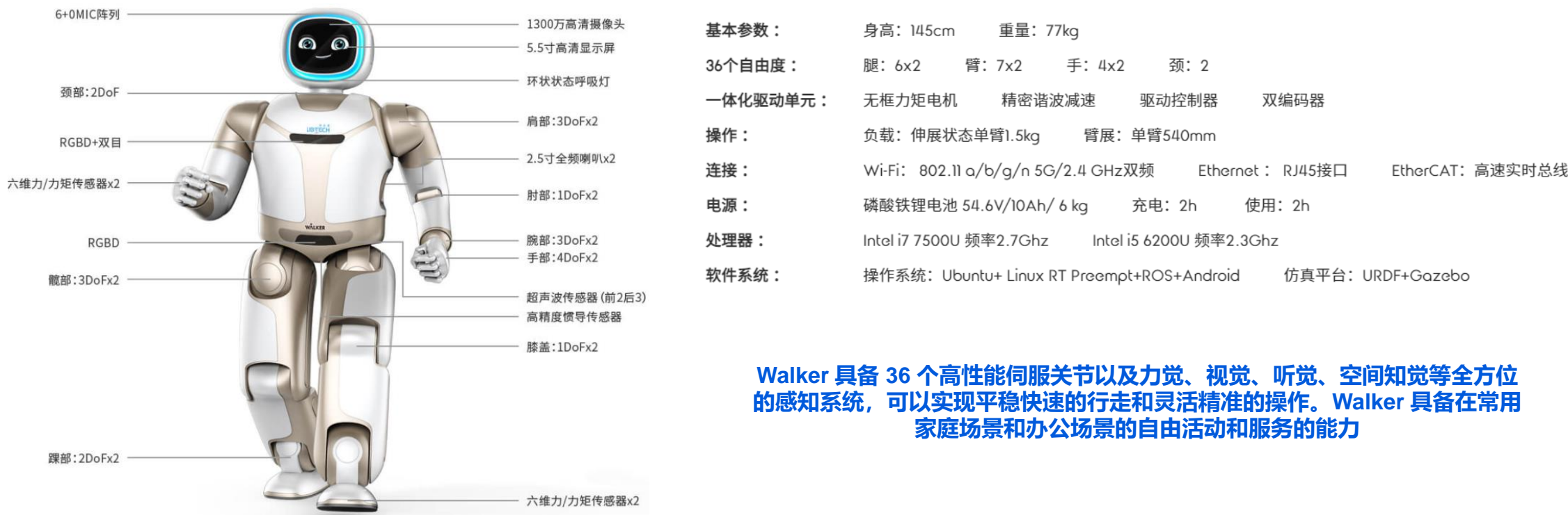
图：优必选Walker机器人的主要结构与基本参数
