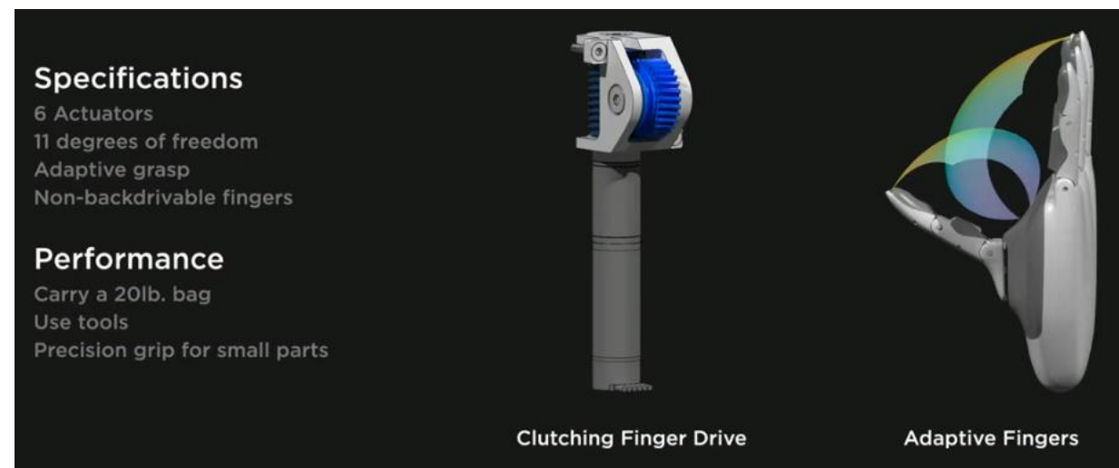
图：Optimus单手6个执行器、11个自由度，可抓起20磅重量
