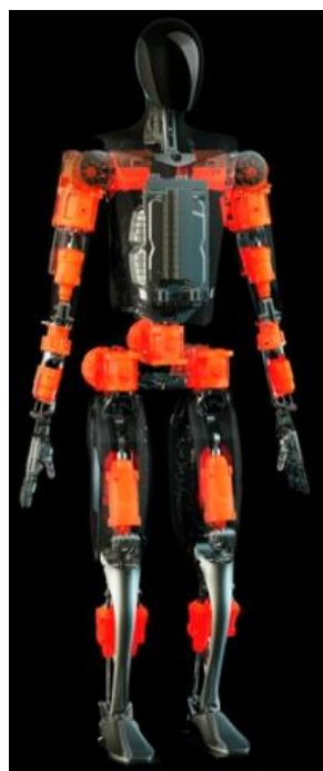
图：特斯拉Optimus分布28个执行器（除手部之外）
