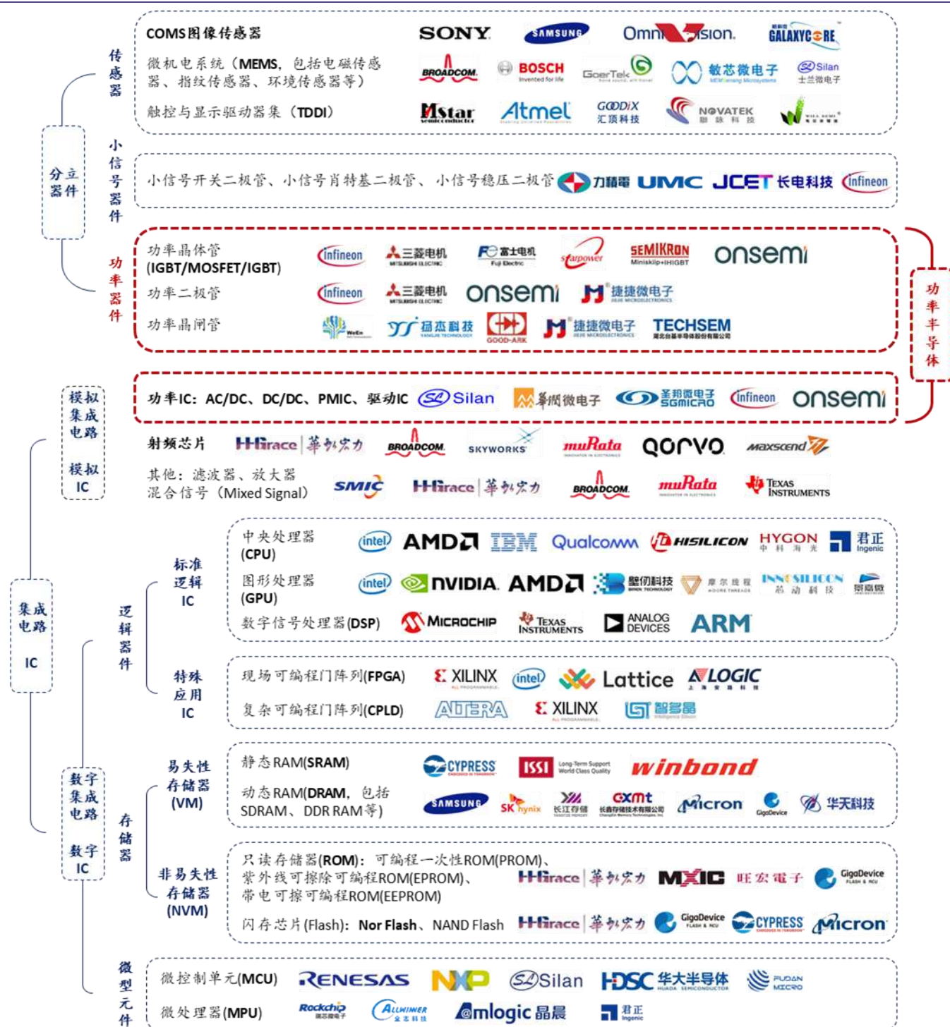
图表 81：功率半导体分类图（功率器件分为二极管、晶体管、晶闸管，其中晶体管包括 BJT、MOSFET、IGBT）
