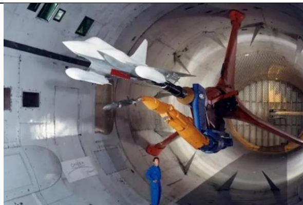
图30.六维力传感器应用于风洞测试
