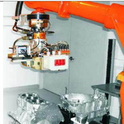
图40.搭载 ATI 六维力传感器的 ABB 装配机器人
