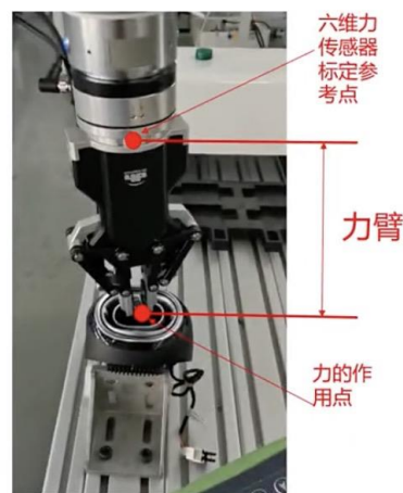
图23.机器人末端执行器受力情况实例
