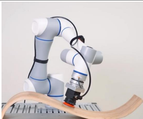
图25.搭载六维力传感器的打磨机器人
