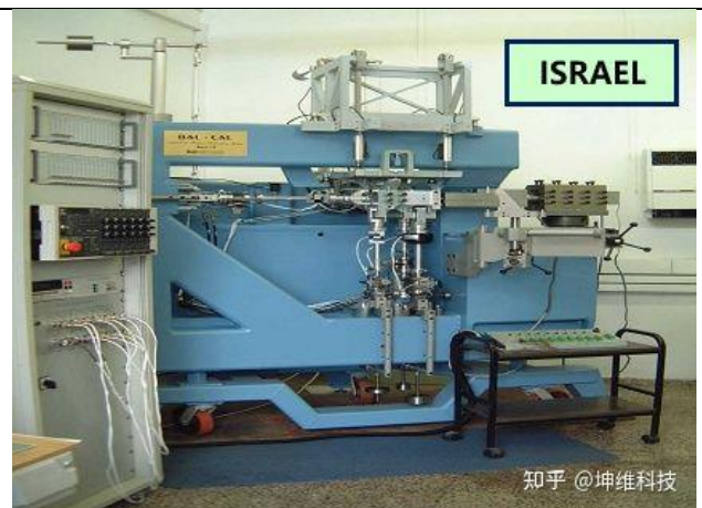
图34.六维联合加载设备
