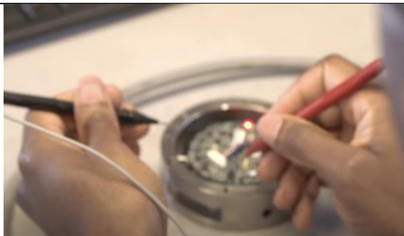
图21.ATI 六维力传感器制造工艺需要人工操作
