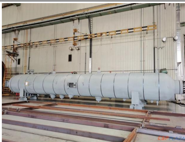
图 20：蒸汽换热器，图为上海电气承建的迪拜光热项目光热汽包产品
