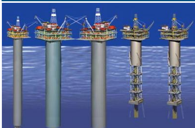
图9: 各种结构型式的 SPAR 平台
