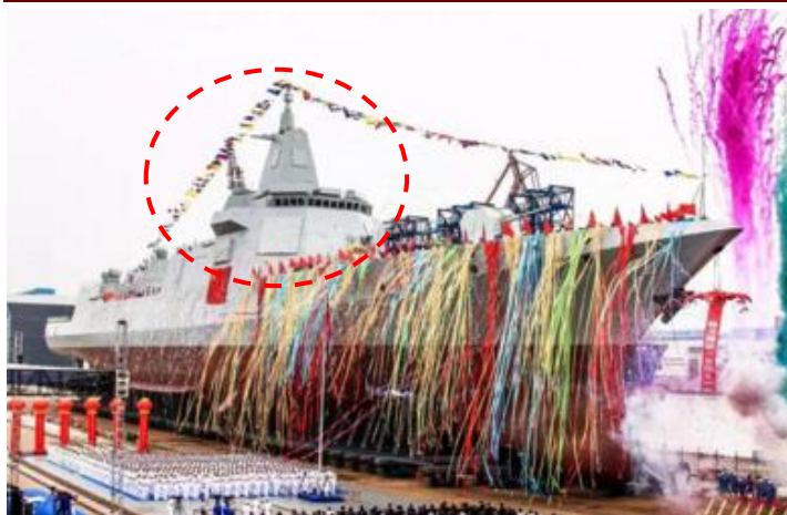
图表 28: 055 型驱逐舰及其装配的多种相控阵雷达
