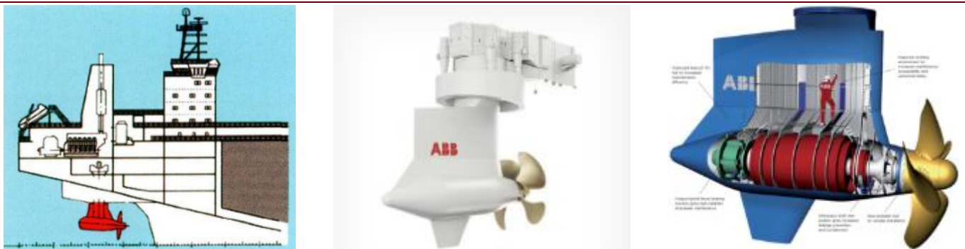
图表 19: 吊舱式电力推进器示意图
