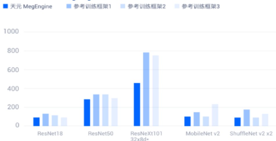
图：旷视MegEngine 和主流开源框架8卡训练耗时 (ms/it) 对比
