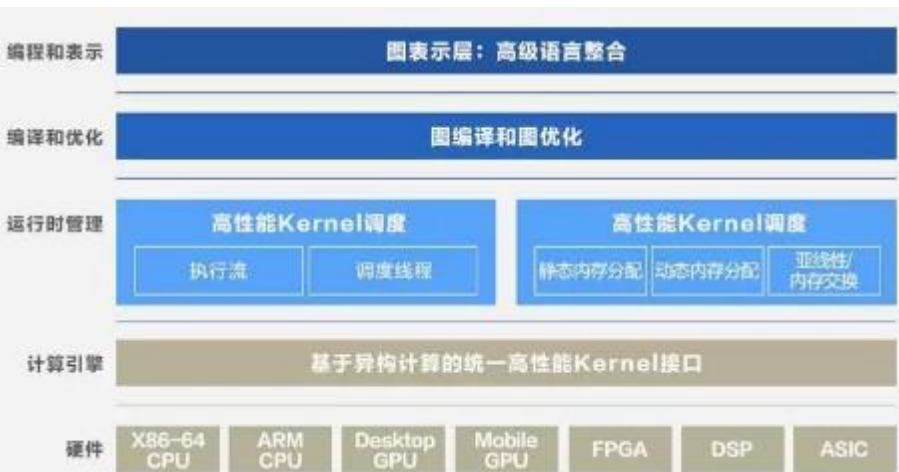
图：旷视MegEngine 的整体架构
