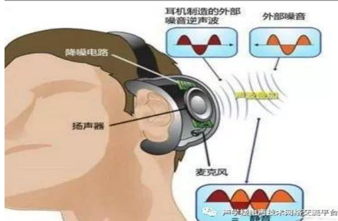
图表7：ANC 主动降噪技术原理
