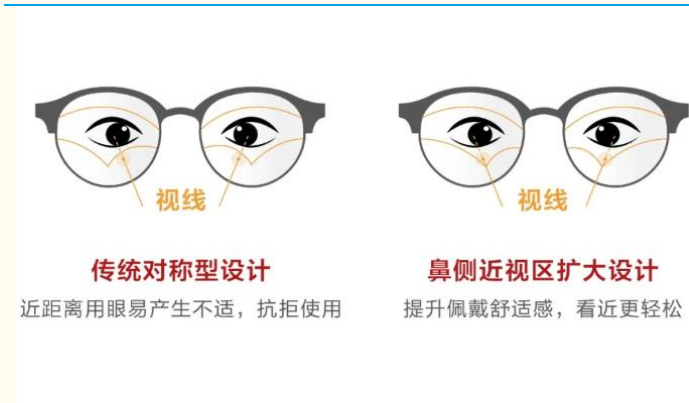
图表 36: 明月镜片鼻侧内偏设计
