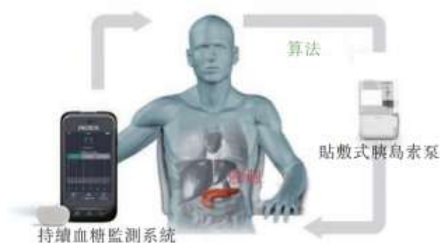
图 72：人造胰腺产品工作示意图
