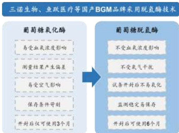
图 64: 国产 BGM 采用葡萄糖脱氢酶技术
